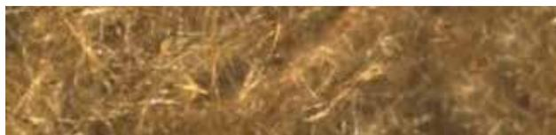
Рис. 3.2. Структура каменной ваты под микроскопом
