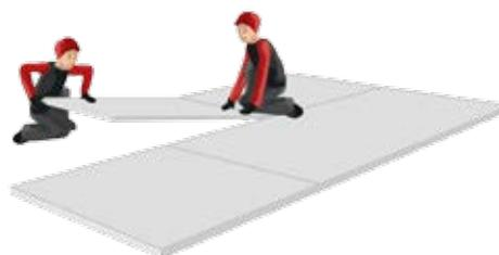
Рис. 4.23. Укладка плит из экструзионного пенополистирола
