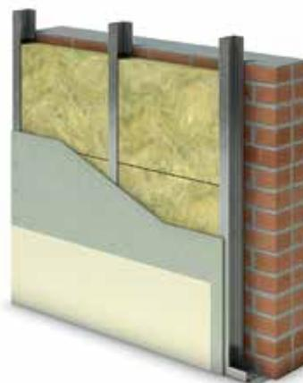
Рис. 4.3. Внутренняя облицовка существующей стены
