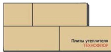
Рис. 4.18б. Схема укладки звукоизоляционных плит ТЕХНОФЛОР СТАНДАРТ
