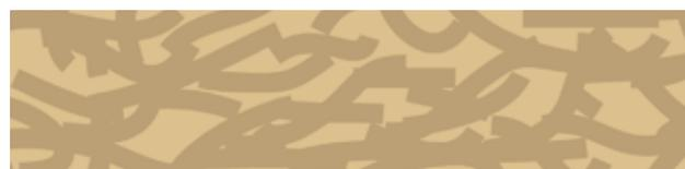
Рис. 3.3. Схема расположения волокон каменной ваты
