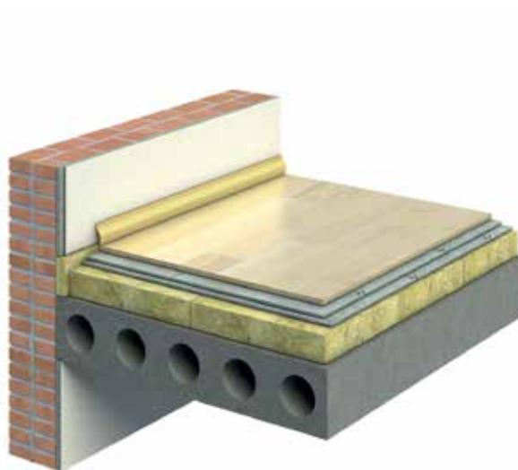
Рис. 4.13. Пример конструкции «плавающего» пола
