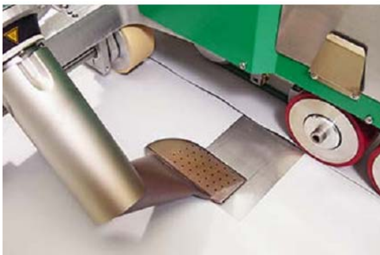
Рисунок 4.23 – Сварка с использованием металлической пластины
