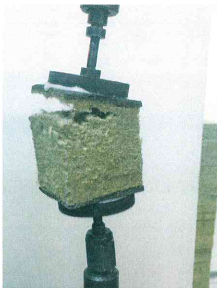
Рисунок 1. Когезионный разрыв по утеплителю
