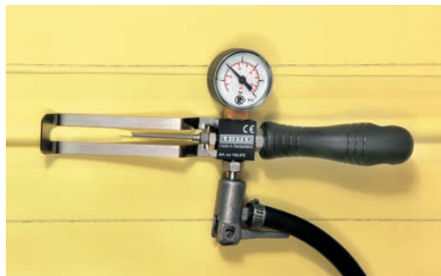
Рисунок М.2 — Контроль качества сварного шва с помощью манометра
