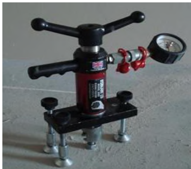
Рис. 5.8 Испытательная машина для определения величины вырывающей нагрузки
