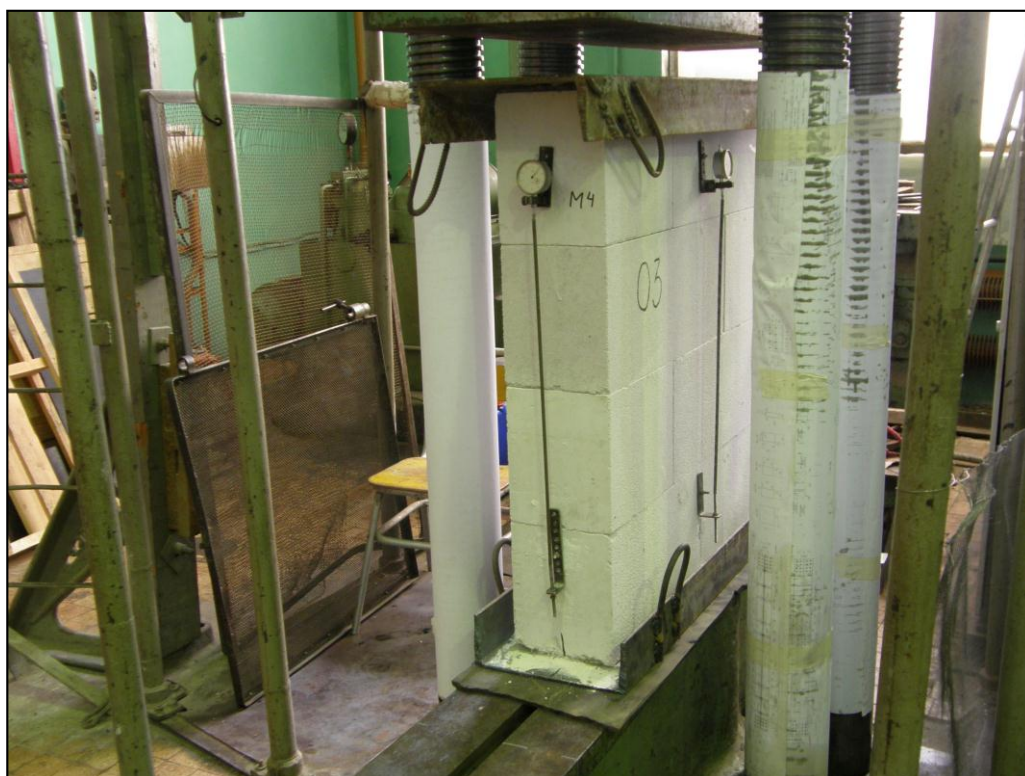
рис. 5. Образец кладки О-3, подготовленный к испытанию
