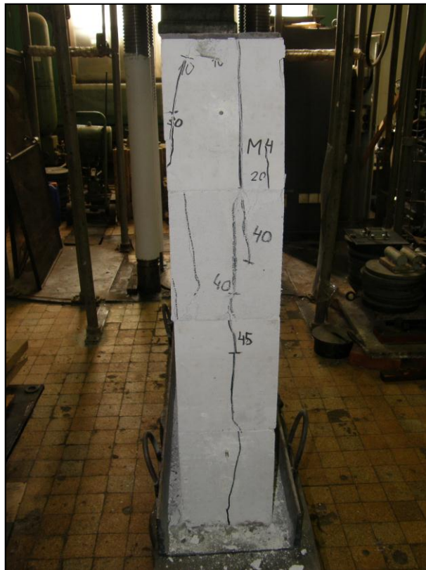
рис. 11. Образец кладки О-3 после испытания на сжатие
