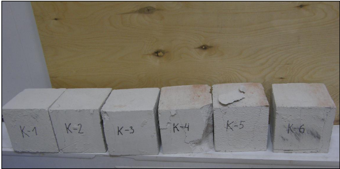
рис. 14. Опытные образцы бетона после испытания на сжатие
