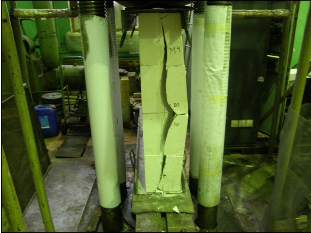
рис. 8. Характер разрушения образца кладки О-1 при испытании на сжатие
