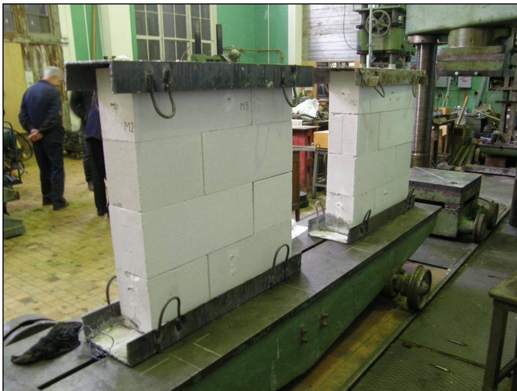
рис. 4. Общий вид образцов кладки О-1 и О-2 перед испытанием на сжатие
