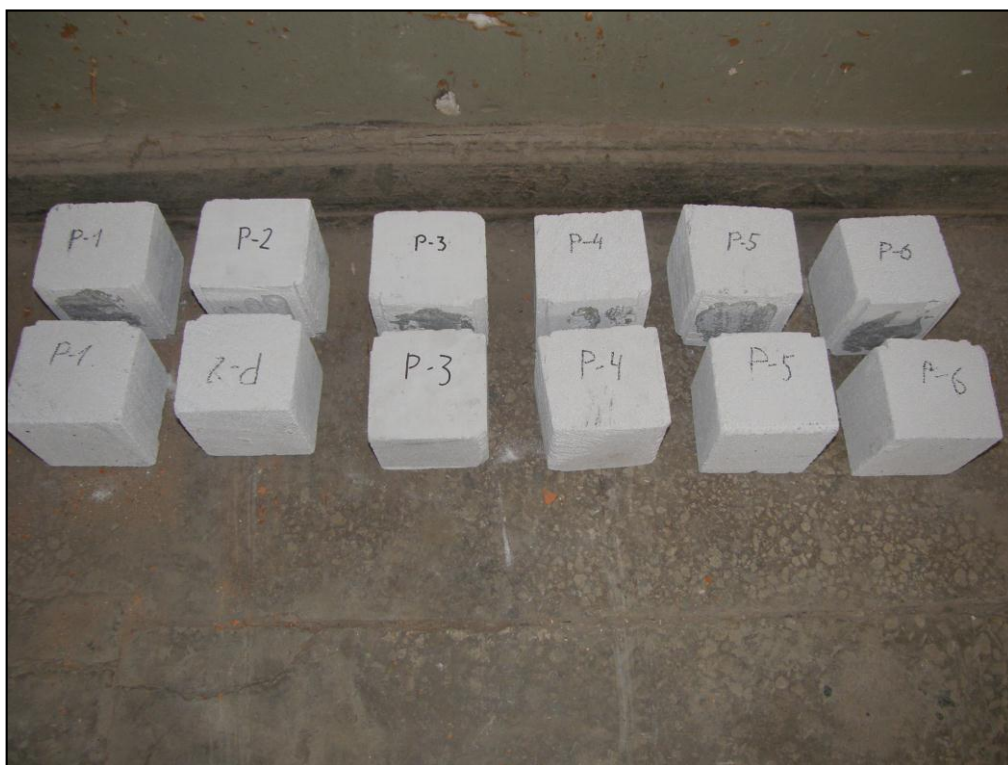
рис. 17. Опытные образцы после испытания на осевое растяжение
