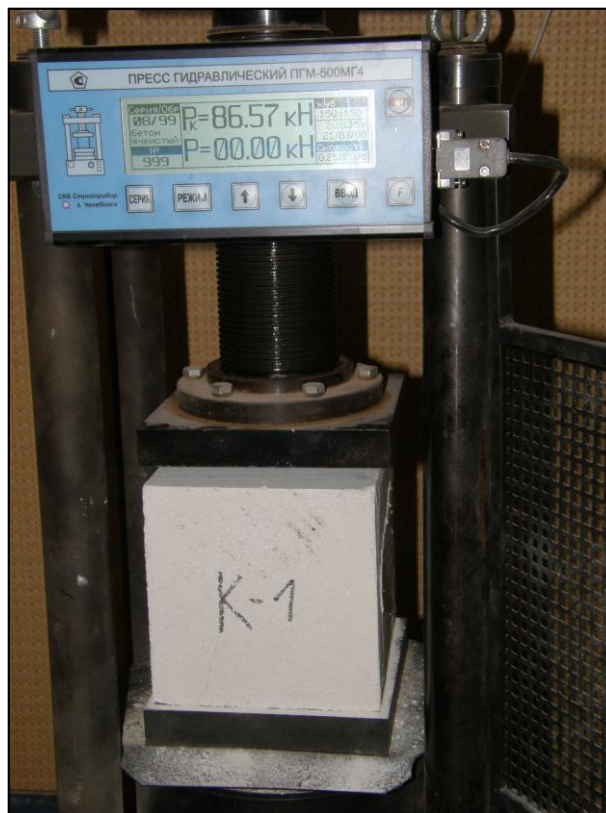
рис. 13. Испытание образца бетона в прессе
