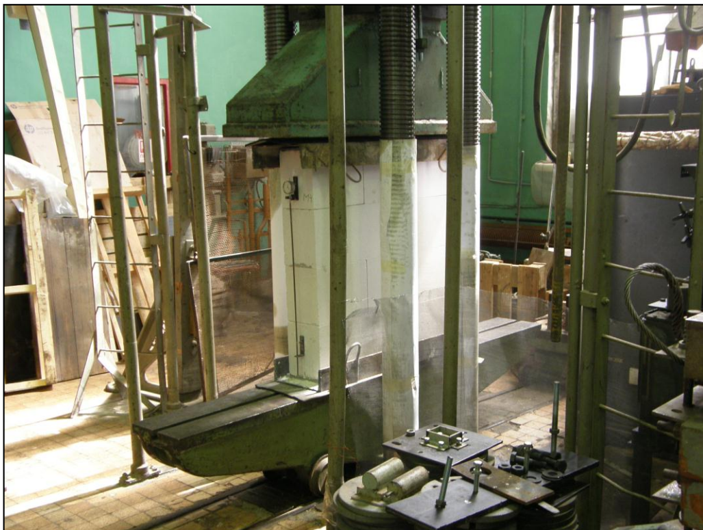
рис. 6. Общий вид прессы в процессе испытания образца кладки на сжатие
