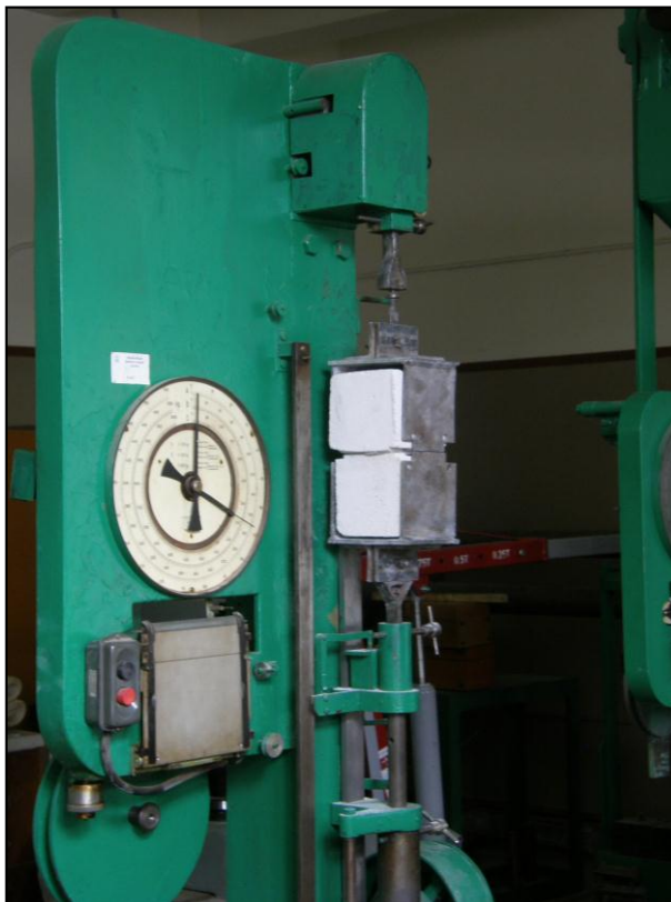
рис. 16. Испытание образца на осевое растяжение
