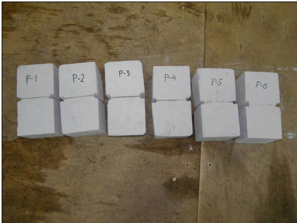
рис. 15. Опытные образцы, подготовленные для испытания на осевое растяжение
