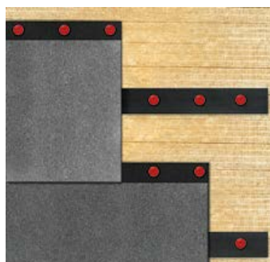
Рис. 3.44. Крепление полосы при устройстве однослойной кровли
