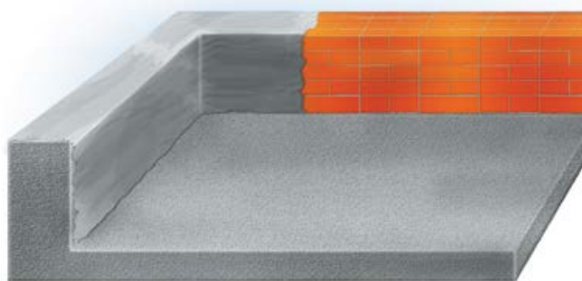
Рис. 3.14. Оштукатуривание вертикальной поверхности
