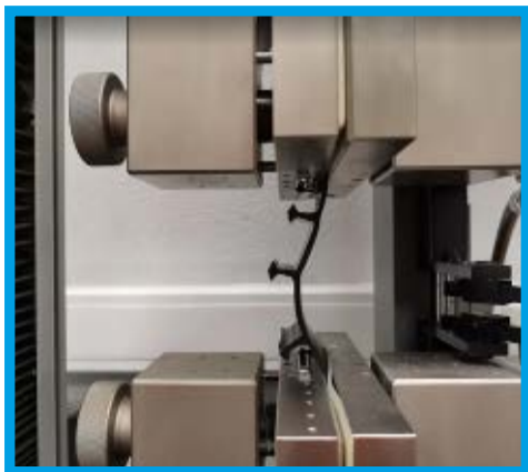
Рис. 10.1. Пример испытания вырезанной гидрошпонки (с реального объекта) на разрывной машине.
