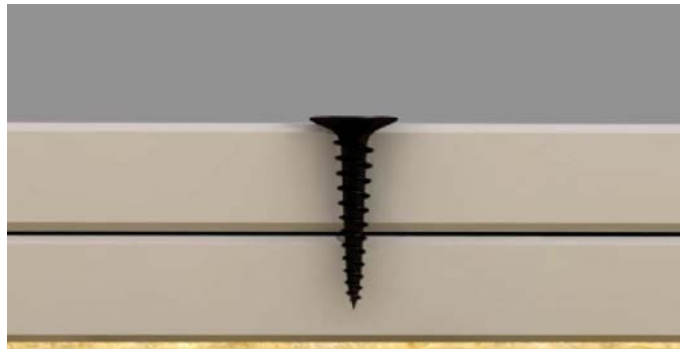
Рис. 11. Соединение двух листов сухой стяжки при помощи самореза
