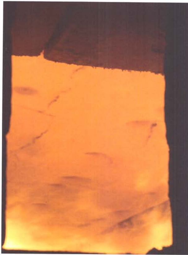
Рис. 7. 245-я мин испытания, окончание огневого воздействия (образец № 1), обрушения минераловатных плит не зафиксировано (вид в смотровое окно)
