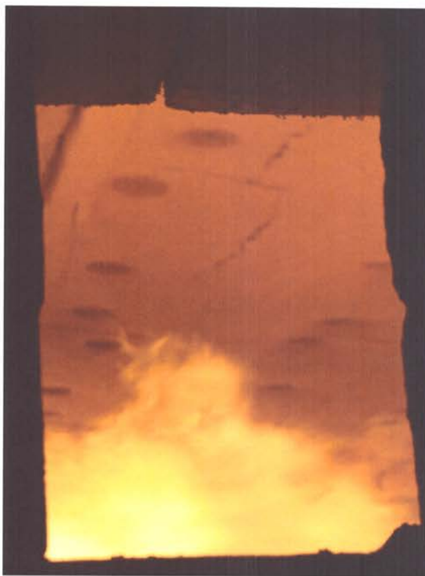
Рис. 6. 210-я мин испытания, незначительное провисание и растрескивание поверхностного слоя минераловатных плит, образец № 1 (вид в смотровое окно)
