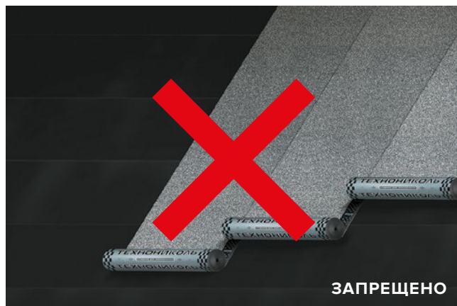
Рис. 4.15. Укладка рулонов второго слоя перпендикулярно рулонам первого слоя
