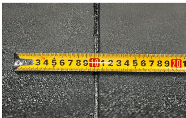
Рис. 4.10. Вытек битумного вяжущего из-под кромки материала
