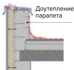
Рис. 2. Решение с доутеплением парапета
