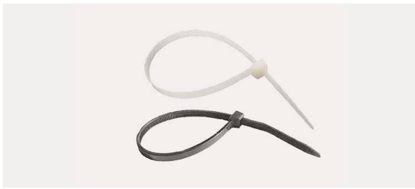
Хомут пластиковый (кабельная стяжка) для крепления труб теплого пола к арматурному каркасу. Длина 150–200 мм
