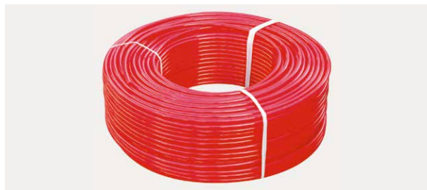
Полимерные трубы из полиэтилена или полипропилена РЕХ для систем отопления с температурой теплоносителя до +95 °С и рабочим давлением не менее 6 бар. Например, трубопроводы RAUTHERM S Ø 14, 17, 20 мм
