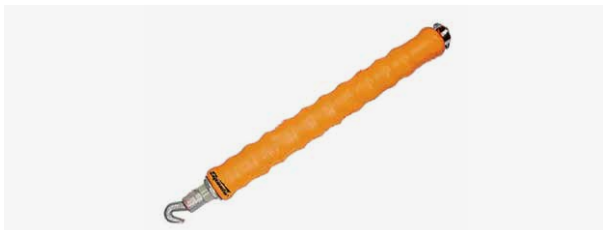
Крюки для вязки арматуры
