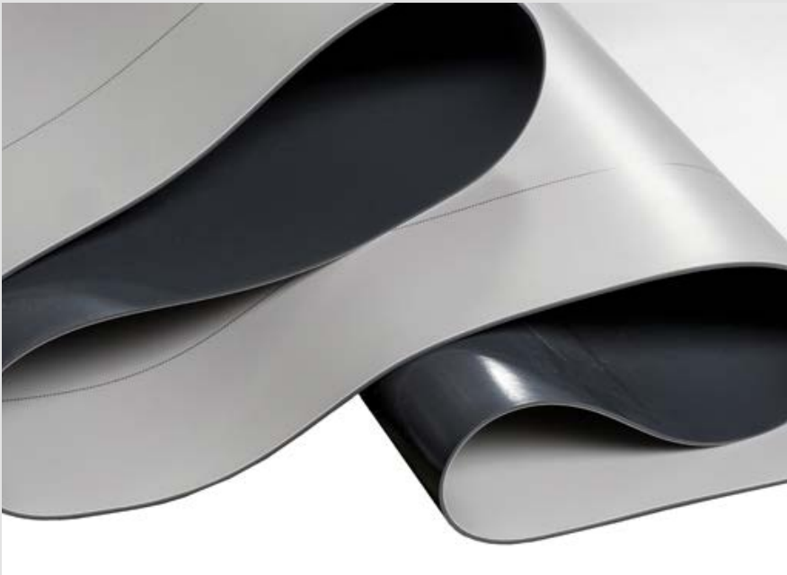
ECOBASE V-UV — неармированная гидроизоляционная ПВХ-мембрана, стабилизированная от воздействия ультрафиолета. Подходит для устройства как фундаментов, так и искусственных водоемов. Варианты толщины: 1,2 мм; 1,5 мм; 2 мм.
