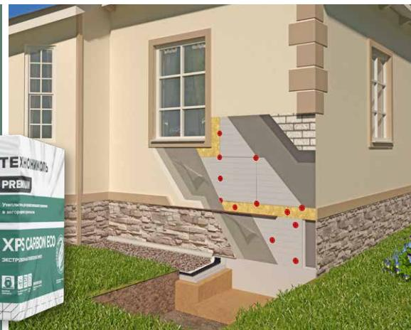
Экструзионный пенополистирол ТЕХНОНИКОЛЬ
