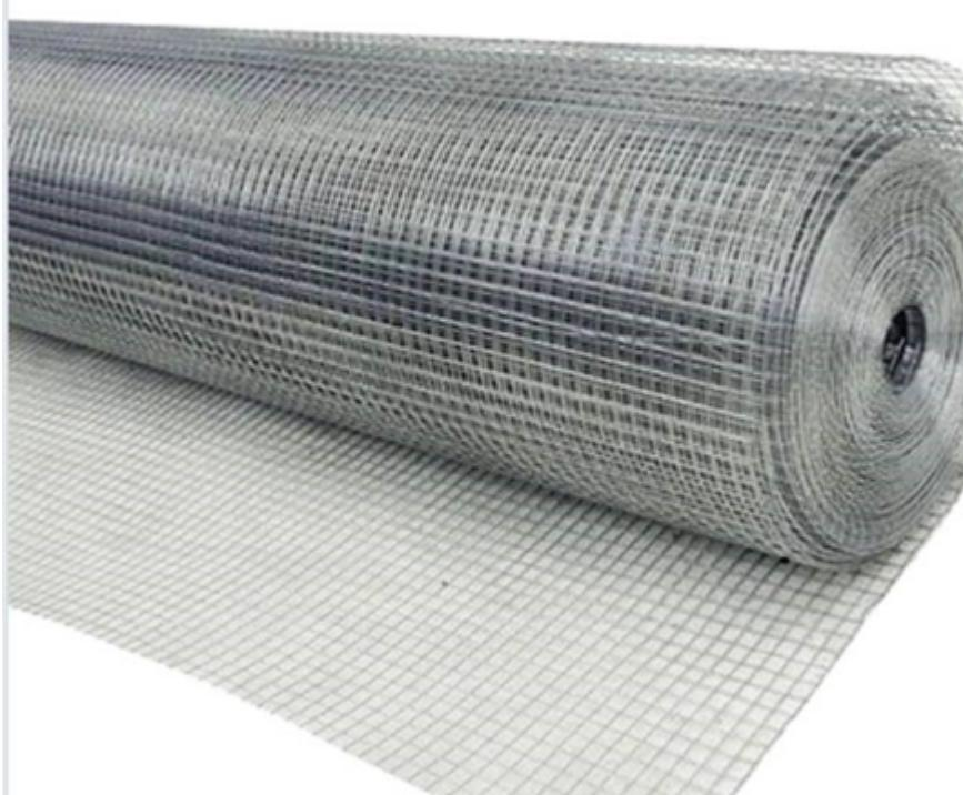
Для устройства армированного слоя в толстослойных штукатурных системах утепления, применяется стальная сетка из проволоки с защитным покрытием (оцинковка), D=1мм с размером ячейки 19×19 мм.
