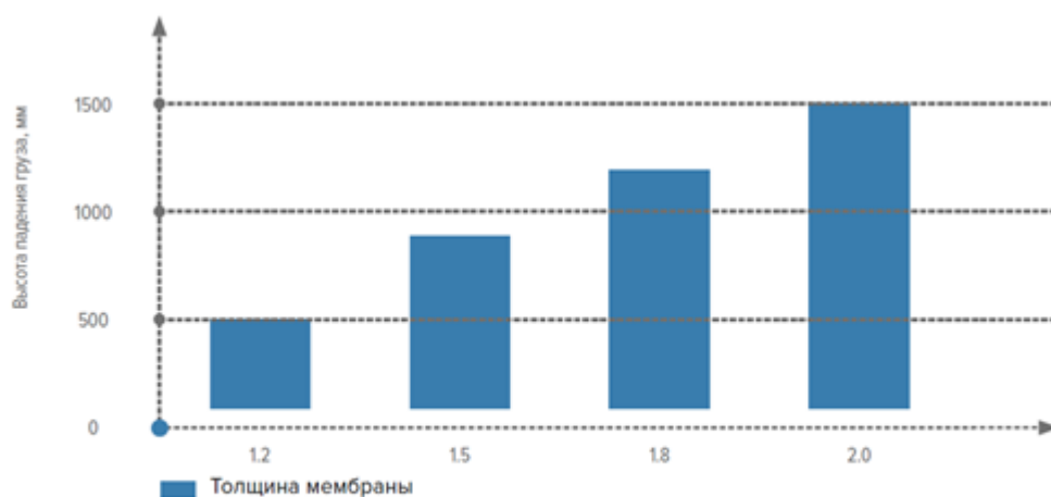
Зависимость показателя ударной прочности от толщины мембраны
