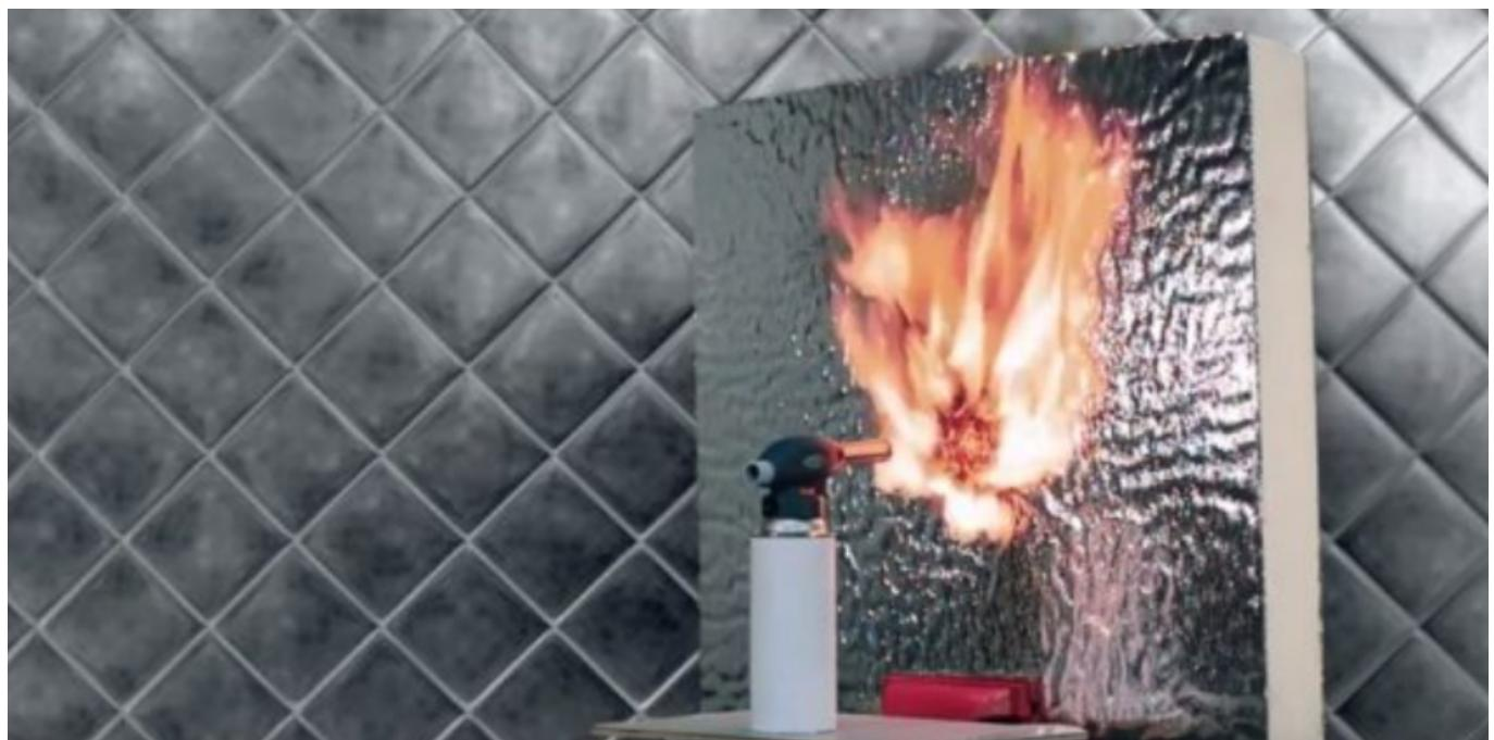
Вспененный полиэтилен назвать пожаробезопасным материалом нельзя. Этот материал относится к термопластам — химическим полимерам, которые под воздействием пламени превращаются в горящий расплав.
