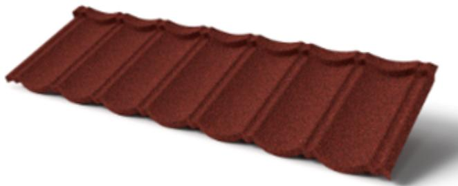
Композитная черепица ТЕХНОНИКОЛЬ LUXARD Roman – это форма панели композитной черепицы LUXARD. Многослойный кровельный материал, выполненный на основе стального листа толщиной 0,45 мм, покрытого с двух сторон слоями алюмоцинка, защитного покрытия и нанесенным на лицевую сторону покрытием, состоящим из акрилового грунта, гранул
