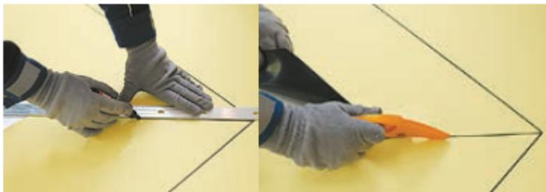
Приступайте к изготовлению второй части элемента. Для этого выполните квадратную заготовку, стороны которой определяются путем измерения длины разреза основной заготовки + 100 мм. Разметьте ее, отступив от края 100 мм.
