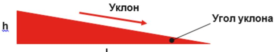
Уклон может измеряться в градусах –  $^\circ$ , процентах – %, а также может быть выражен коэффициентом уклона  $i$ .
