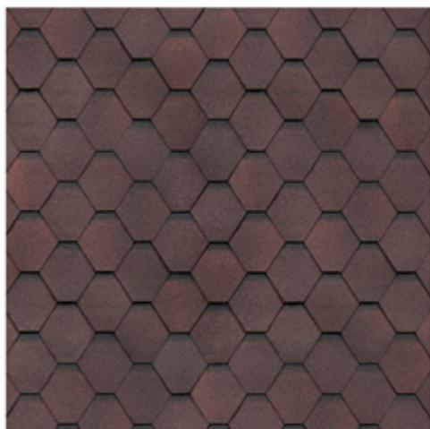
Гибкая черепица ТЕХНОНИКОЛЬ, серия УЛЬТРА – это штучный битумосодержащий кровельный материал. Изготавливается нарезанием листов из рулонного материала, получаемого путем пропитки и покрытия стекловолокнистой основы битумно-полимерным вяжущим, с последующим нанесением различных видов защитных покрытий. В Серии УЛЬТРА представлены две формы нарезки: «соната», «аккорд». Гарантийный срок службы – 50 лет.
