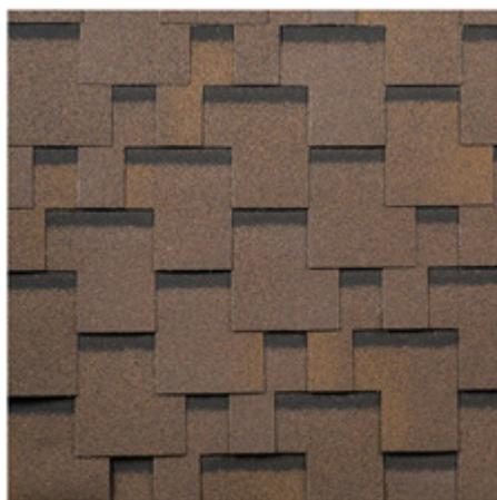
Гибкая черепица ТЕХНОНИКОЛЬ, серия ОПТИМА это штучный, битумосодержащий кровельный материал. Изготавливается нарезанием листов из рулонного материала, получаемого путем пропитки и покрытия стекловолокнистой основы битумным вяжущим, с последующим нанесением различных видов защитных покрытий. Гарантийный срок службы – 10 лет.
