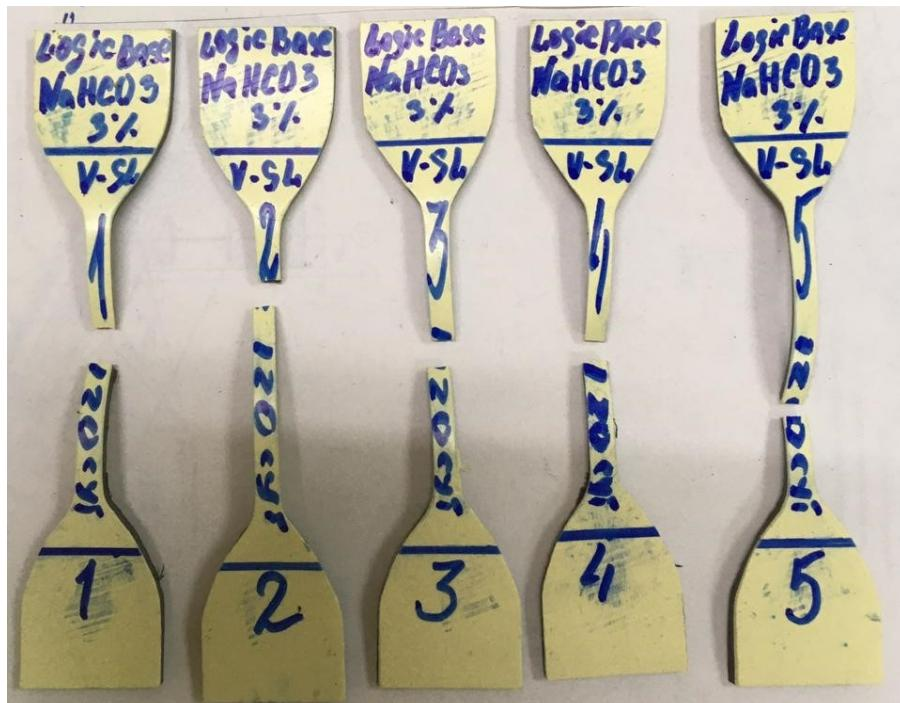
Образцы рулонного гидроизоляционного полимерного материала **LOGICBASE V-SL** по определению его деформативно-прочностных показателей после воздействия на него  $\text{NaHCO}_3$  (3 %) в течение 30 (а), 90 (б) и 120 (в) суток.
