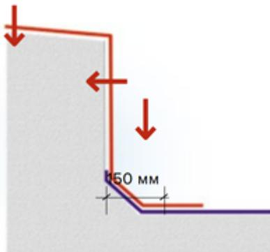
Подготовьте дополнительный нижний слой из материала Техноэласт ЭПП для заведения на плоскость парапета.
