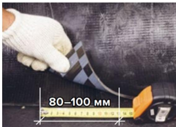
Скатайте подготовленную заготовку в рулон. Намотку лучше производить на картонную шпулю при ручной подаче рулона.
