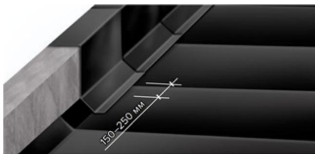
Укладку дополнительного нижнего слоя Техноэласт ЭПП на парапет нужно начинать с пониженных участков кровли ендов для предотвращения противошовки. Вода должна стекать
