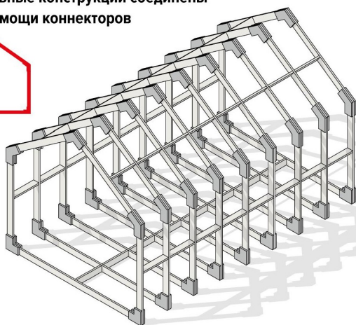
Рис. 24 Пространственные каркасы ангарного типа
