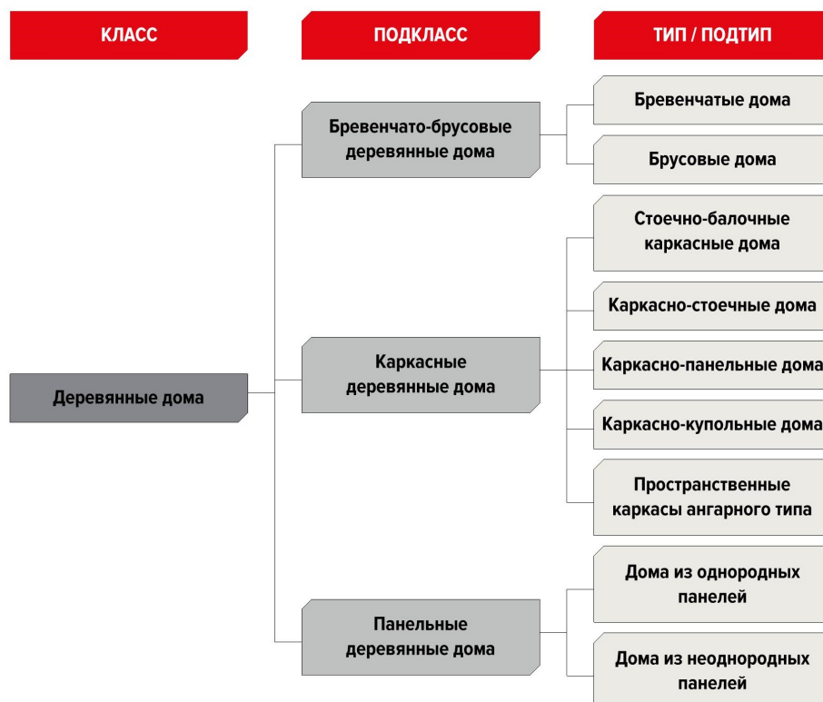
Рис. 3 Основные типы деревянных домов по технологии возведения
