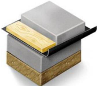
В месте будущего соединения горизонтальной и вертикальной гидроизоляционных мембран защиту выполните щитовыми материалами (листами фанеры и т. д.), что позволит защитить мембрану от механического повреждения и быстро их разобрать при дальнейших работах по наплавлению.
