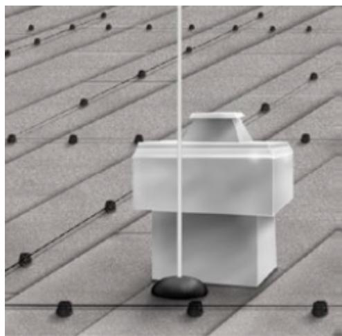
Все элементы молниезащиты должны быть соединены между собой с помощью молниеприемной сетки. Молниеприемная сетка соединяется с тоководами. Тоководы проходят по фасаду здания к заземлителю.
