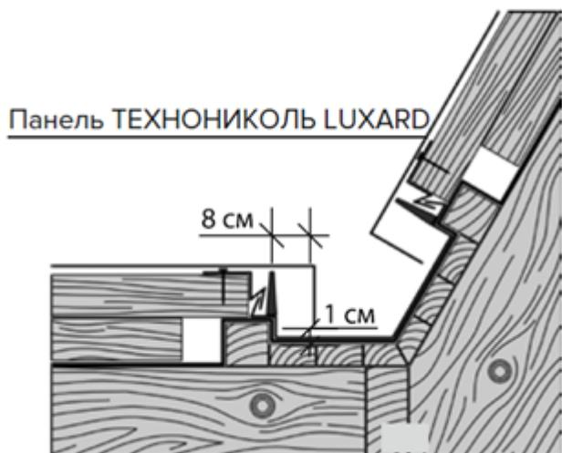
Панель композитной черепицы ТЕХНОНИКОЛЬ LUXARD заведите на элемент ендовы на 8 см и загните вниз так, чтобы расстояние между нижним отгибом композитной черепицы и элементом ендовы составляло 1 см.
