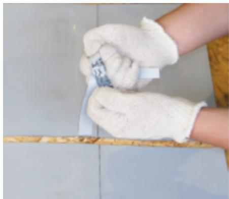
Для определения качества шва без применения оборудования можно использовать полосу сваренной мемbrane шириной **20-30 мм**. Разорвите полоску сваренной мемbrane руками.
