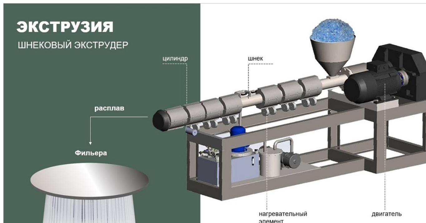
Общая схема вытягивания первичных волокон
