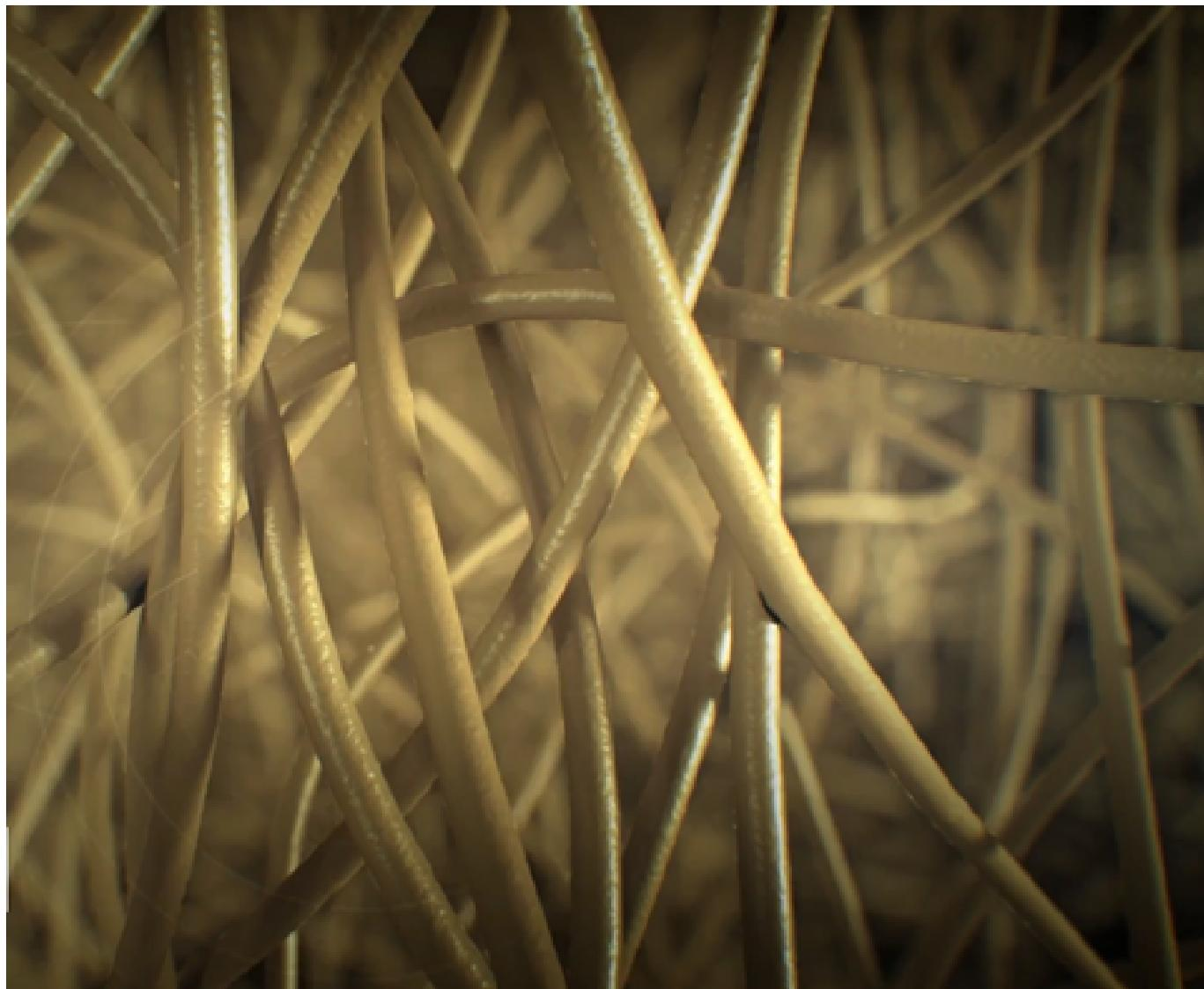
Они имеют следующий механизм поглощения звуковой энергии: звуковые волны, встречаясь с поверхностью пористого материала, приводят воздух внутри пор и сами волокна в колебательное движение. Поры оказывают большое сопротивление потоку воздуха(звуковой волне) через них, благодаря чему движение воздуха в порах и за счет гибких волокон тормозится, и в результате вязкого трения часть звуковой энергии превращается в теплоту в последствии рассеиваясь и теряя силу.
