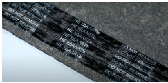
На производстве гибкой черепице гонты в пачки укладывают таким образом, чтобы клейкий слой с одного гонта попадал на несъемную полосу другого. Более подробно можно посмотреть в ролике на официальном канале:
