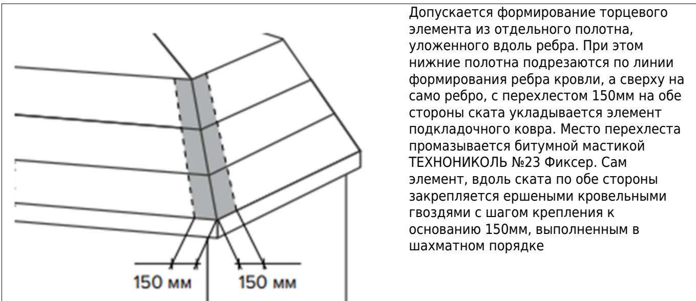
**ВАЖНО!** Монтаж производить на сухое, жесткое, ровное, влагостойкое, чистое от мусора и пыли основание. Перед монтажом следует подождать, когда каркас деревянного здания и само деревянное основание усядет по всей площади (отдаст накопленную влагу), чтобы исключить возможность образования волн и неровностей на смонтированной кровле.
