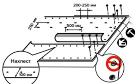
МОНТАЖ С ПОМОЩЬЮ КРОВЕЛЬНЫХ ЕРШЕНЫХ ГВОЗДЕЙ И МЕТАЛЛИЧЕСКИХ ОЦИНКОВАННЫХ СКОБ
