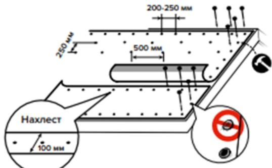
МОНТАЖ С ПОМОЩЬЮ КРОВЕЛЬНЫХ ЕРШЕНЫХ ГВОЗДЕЙ
