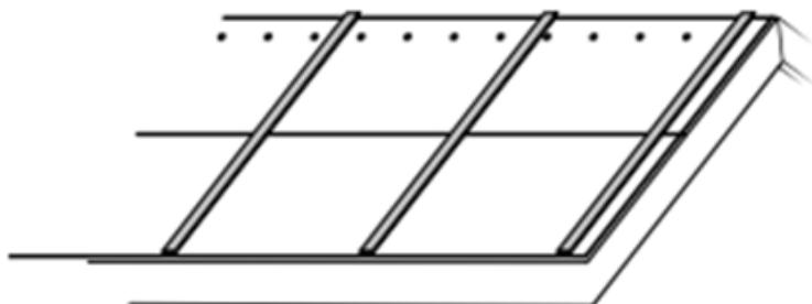
При использовании подкладочного ковра в качестве временной кровли осуществляется механическое крепление только по периметру материала без механической фиксации его по центру (GL / GL LIGHT / GL PLUS / NEXT FIX). После крепления материала, параллельно фронтонному свесу осуществляется дополнительное крепление подкладочного ковра при помощи реек или пяток с шагом крепления 500мм
