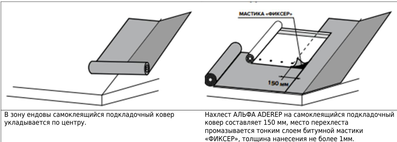
**ВНИМАНИЕ! Допустимо крепить подкладочный ковер АЛЬФА ANDEREP на широкие оцинкованные скобы при одновременном монтаже кровельного покрытия.**
