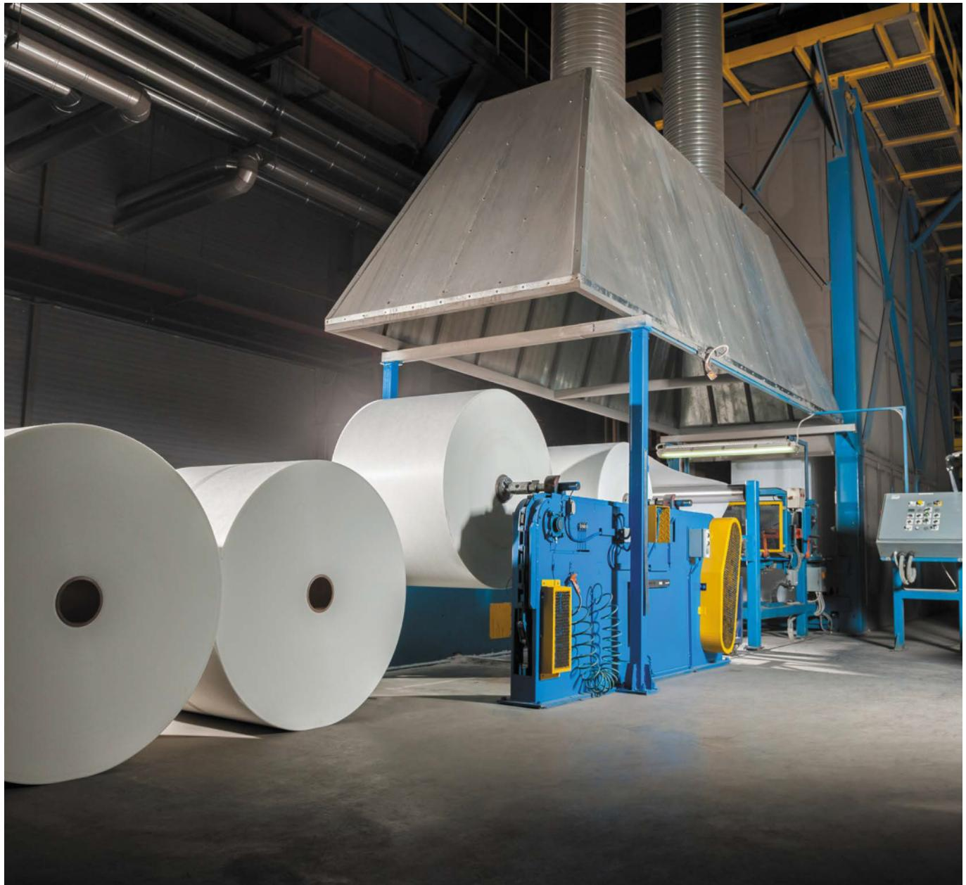
Завод Стекловолокна производит стеклохолст по мокрой технологии из стеклянных волокон специального диаметра и длины, скрепленных между собой органическими добавками без формальдегида.
