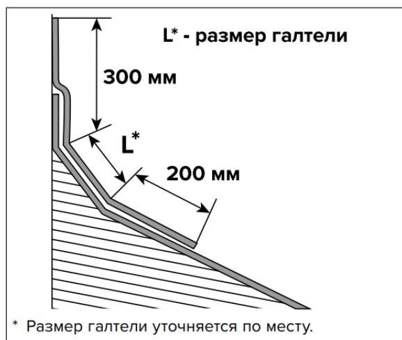
Для герметизации дымовых и вентиляционных труб делают выкройку из коньково-ендового ковра (КЕК) либо из металла с антикоррозийным покрытием.
