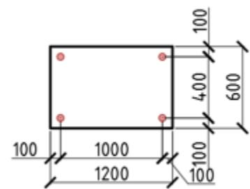
1. Крепление теплоизоляционных плит из каменной ваты
