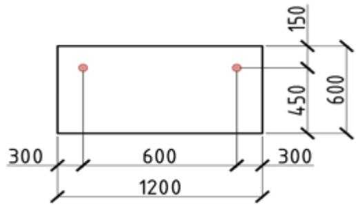
1. Крепление теплоизоляционных плит PIR
