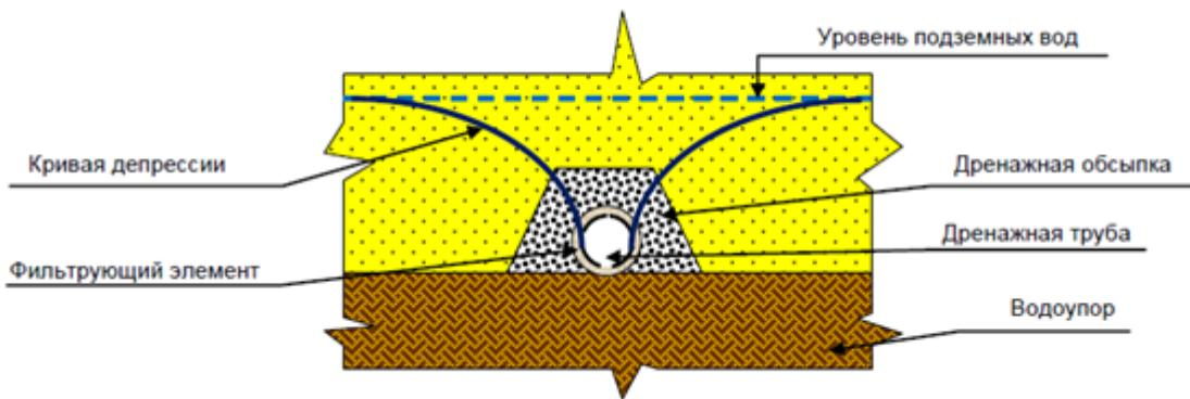
Дренаж несовершенного типа закладывается выше водоупора. Подземные воды поступают в трубчатый дренаж со всех сторон, поэтому дренирующая обсыпка должна быть замкнутой со всех сторон дренажной трубы.
