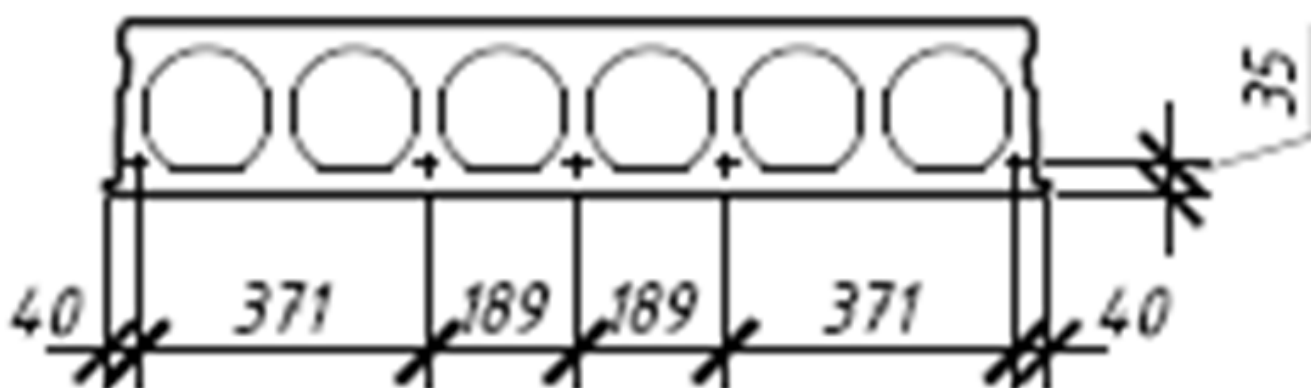
Рисунок 3. Расчетное сечение многопустотной плиты
