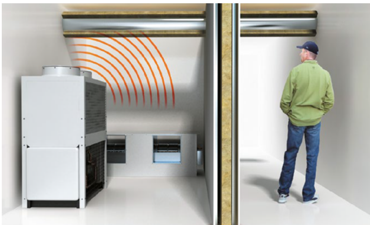
Снижение шума при применении технической изоляции:
