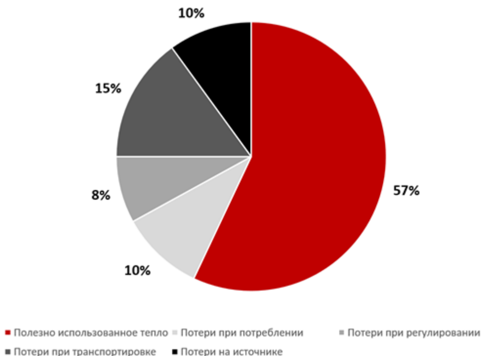
Потери тепла в централизованной системе отопления
