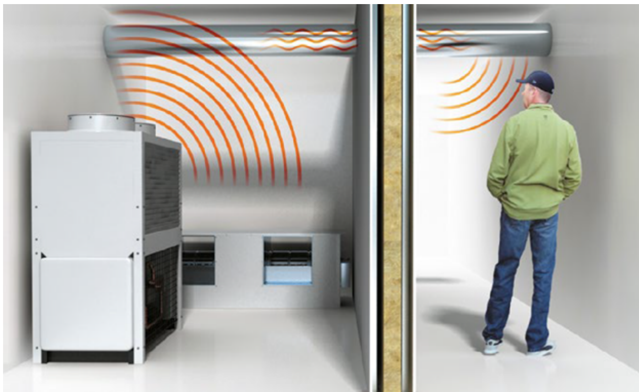
Снижение шума при применении технической изоляции:
