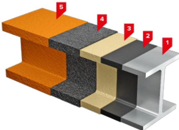
Применяется для улучшения характеристик огнестойкости стальных конструкций в условиях открытой атмосферы, в сырых неотапливаемых помещениях, а также в закрытых отапливаемых помещениях при температуре до минус 60°C и влажности до 100%.
