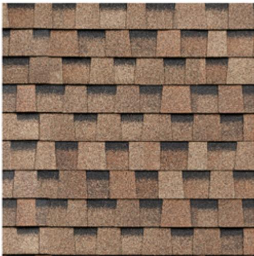
Многослойная черепица ТЕХНОНИКОЛЬ SHINGLAS, коллекция ВЕСТЕРН – это штучный битумосодержащий кровельный двухслойный материал. Изготавливается нарезанием листов из рулонного материала, получаемого путем пропитки и покрытия стекловолокнистой основы битумным вяжущим, с последующим нанесением различных видов защитных покрытий и склейкой двух листов разной формы. Запатентованная форма, которая не имеет аналогов в мире. Гарантийный срок службы – 55 лет.
