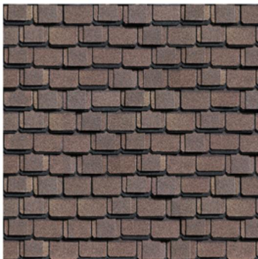
Многослойная черепица ТЕХНОНИКОЛЬ SHINGLAS, серия АТЛАНТИКА – это штучный битумосодержащий кровельный трехслойный материал. Изготавливается нарезанием листов из рулонного материала, получаемого путем пропитки и покрытия стекловолокнистой основы битумным вяжущим, с последующим нанесением различных видов защитных покрытий и склейкой трех листов разной формы. Рисунок кровли объемный, рельефный, эксклюзивный. Гарантийный срок службы – 60 лет.
