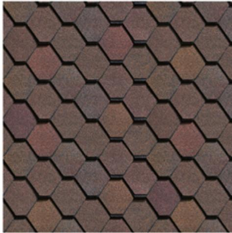
Многослойная черепица ТЕХНОНИКОЛЬ SHINGLAS, коллекция КОНТИНЕНТ – это штучный битумосодержащий кровельный трехслойный материал. Изготавливается нарезанием листов из рулонного материала, получаемого путем пропитки и покрытия стекловолокнистой основы битумным вяжущим, с последующим нанесением различных видов защитных покрытий и склейкой трех листов разной формы. Рисунок кровли объемный, рельефный, эксклюзивный. Гарантийный срок службы – 60 лет.
