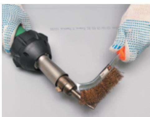
Нагар с сопла по мере его накопления удаляйте с помощью медной металлической щетки.
