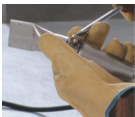
Насадка сопла должна быть закреплена на шейке сварочного аппарата должным образом.
