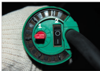
1 — Регулятор температуры 2 — Переключатель Включение/выключение оборудования
