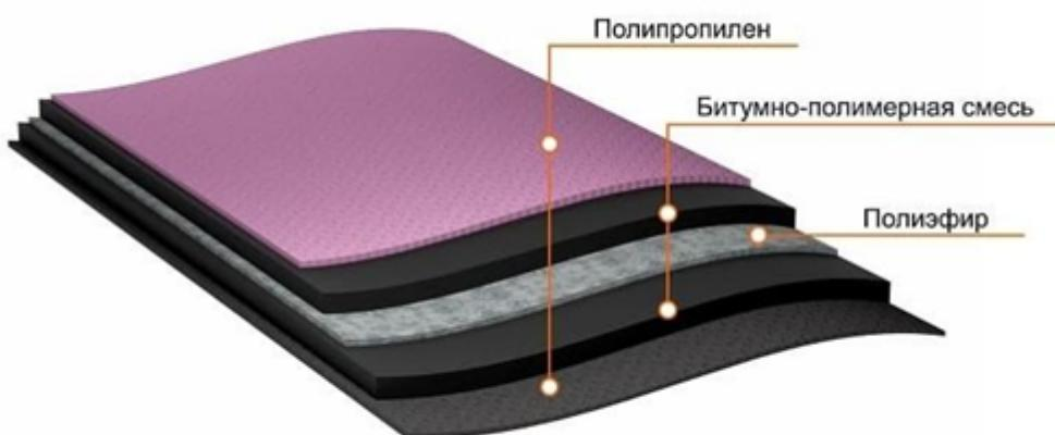
Главное гидроизоляционное свойство подкладочному ковру придает пропитка битумом. При производстве подкладочных ковров применяется улучшенный (модифицированный) битум. В зависимости от выбора модификатора будут отличаться свойства – эластичность, «самозаживление», способность сопротивляться экстремально низким и, наоборот, высоким температурам.
