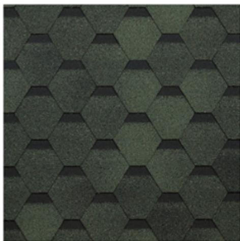
Гибкая черепица ТЕХНОНИКОЛЬ, серия ФИНСКАЯ ЧЕРЕПИЦА - это штучный, битумосодержащий кровельный материал. Изготавливается нарезанием листов из рулонного материала, получаемого путем пропитки и покрытия стекловолокнистой основы битумным вяжущим, с последующим нанесением различных видов защитных покрытий. Гарантийный срок службы - 20 лет.
