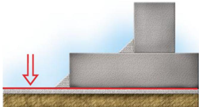
Перед наплавлением РБМ на горизонтальные поверхности разверните весь рулон на подготовленном основании, примерьте и выровняйте его по отношению к уже уложенному рулону, обеспечив требуемый нахлест по продольным и поперечным кромкам (см. ниже). Желательно дать отлежаться материалу в развернутом состоянии для уменьшения возможности образования дефектов в уложенной мемbrane.
