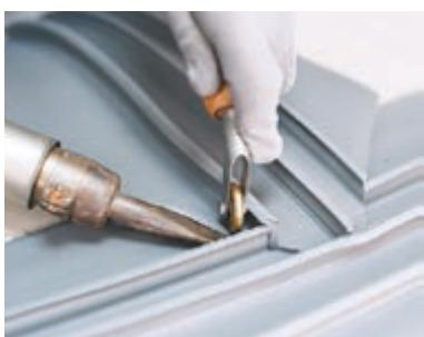
После того как всестыки ребер и плоские части заготовки проварены, переверните элемент и проварите нахлест с обратной стороны.
