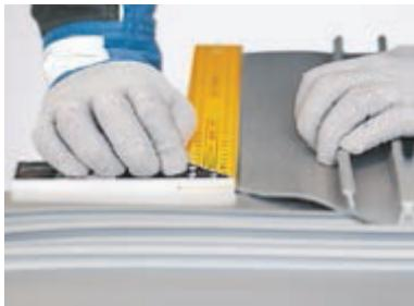
Удалите часть ребра второй заготовки, которая мешаетстыковке.
