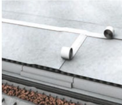
После монтажа мембран приступайте к формированию балластного слоя. Используйте гравий фракцией 20-40 мм. Минимальный вес балласта на  $\text{м}^2$  составляет 50 кг. Этот слой может быть финишным если Вы не планируете эксплуатировать кровлю.
