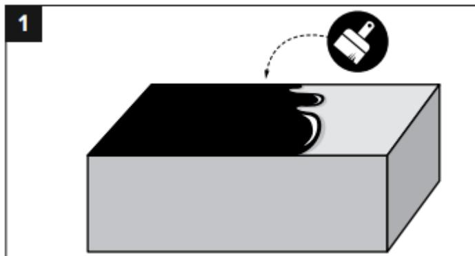
1. На основание, обработанное mastикой уложить материал так, чтобы он выступал за габариты будущих стен на ширину не менее 25–50мм.
